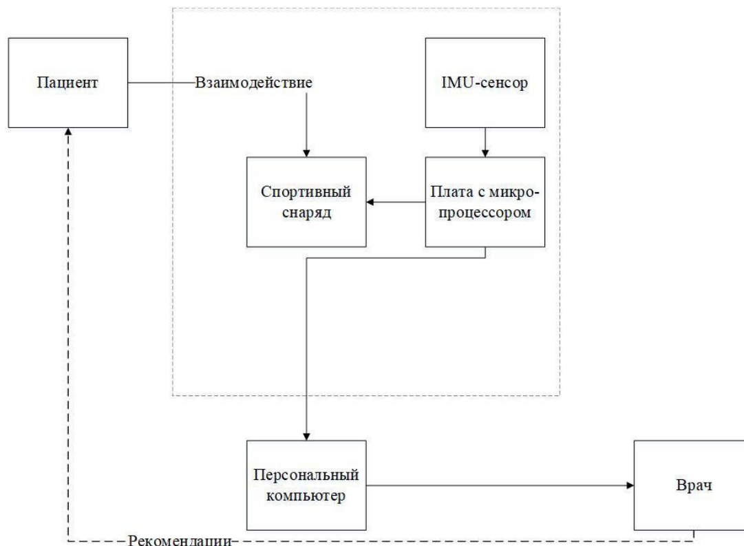
Рис. 1. Структурная схема биотехнического устройства Fig. 1. Structural scheme of the biotechnical device
